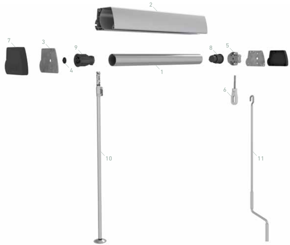
Terminal Cofre explosionado
